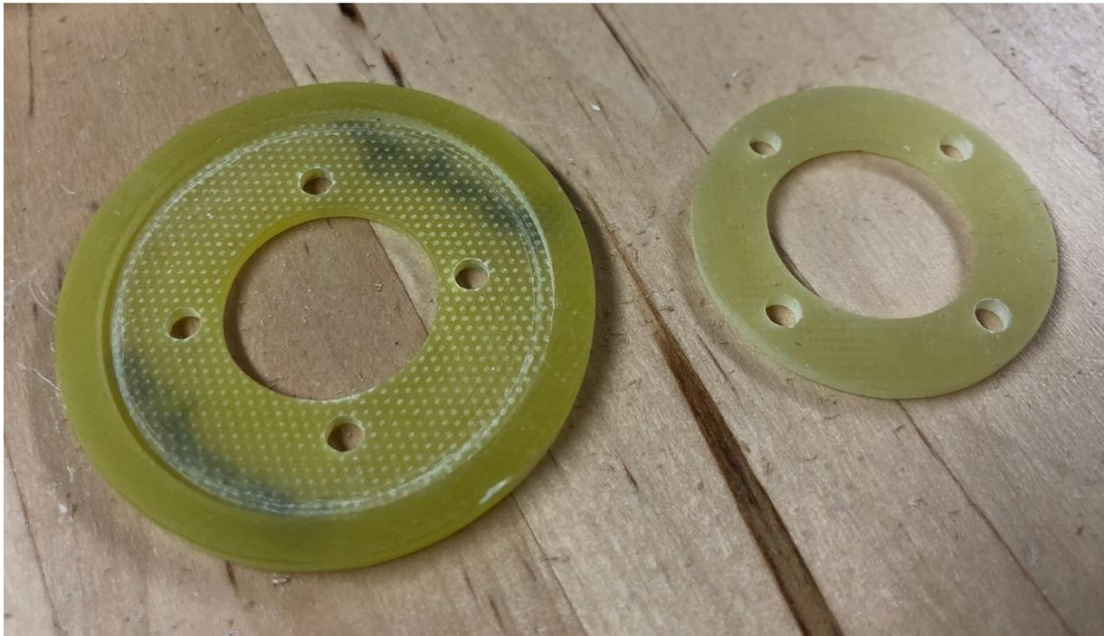
Der verwendete Leomotion Motor braucht einen 1,5mm Abstandhalter in Form eines GFK Spants der in den Rumpfkopf innen zu kleben ist. Dieser ebenfalls gefräste Spant wurde mit Epoxidharz eingestrichen und in den Rumpfkopf gelegt. Die Ausrichtung wurde durch 3mm Stahlstifte
